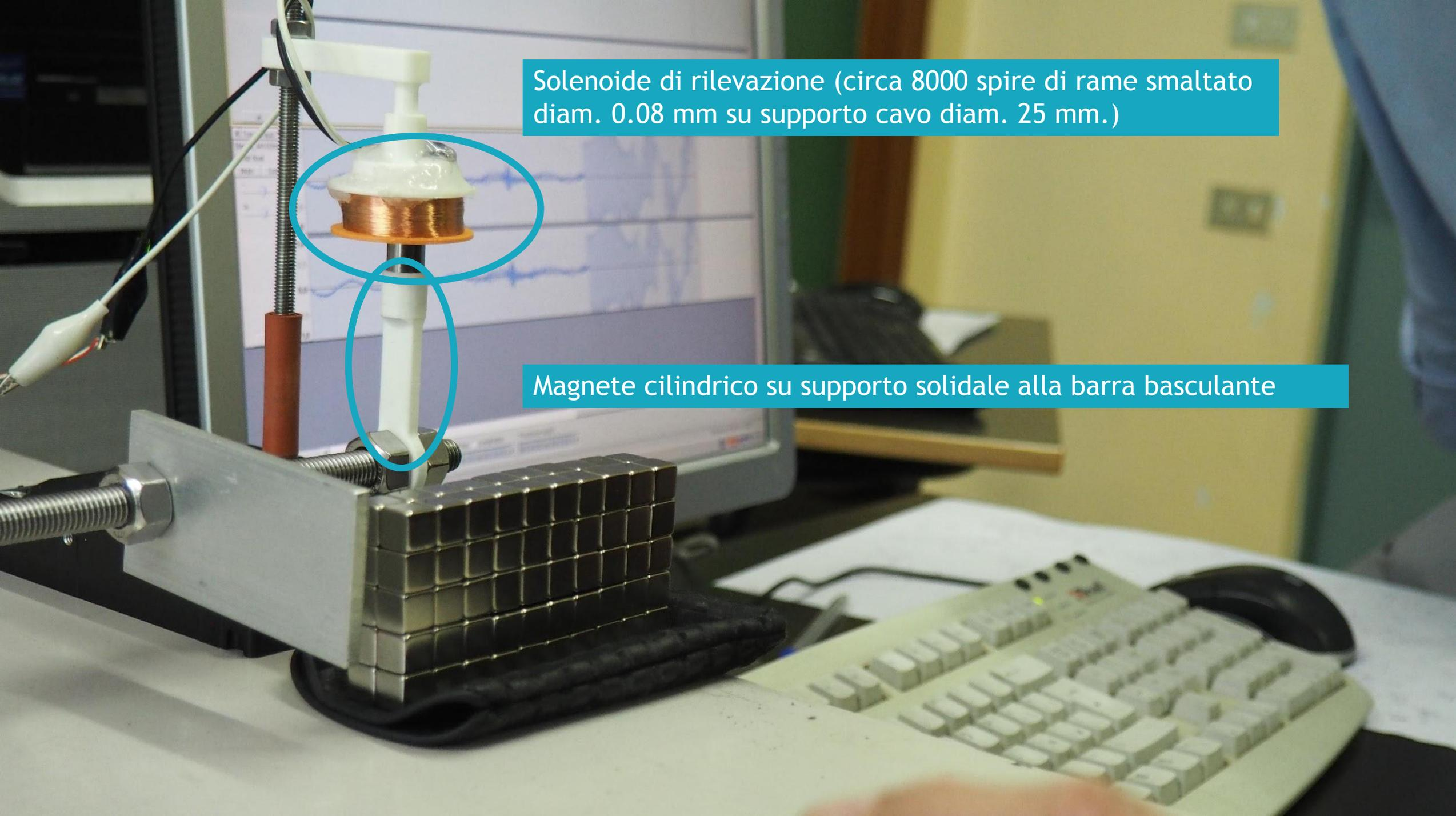
Solenoide di rilevazione (circa 8000 spire di rame smaltato diam. 0.08 mm su supporto cavo diam. 25 mm.)
