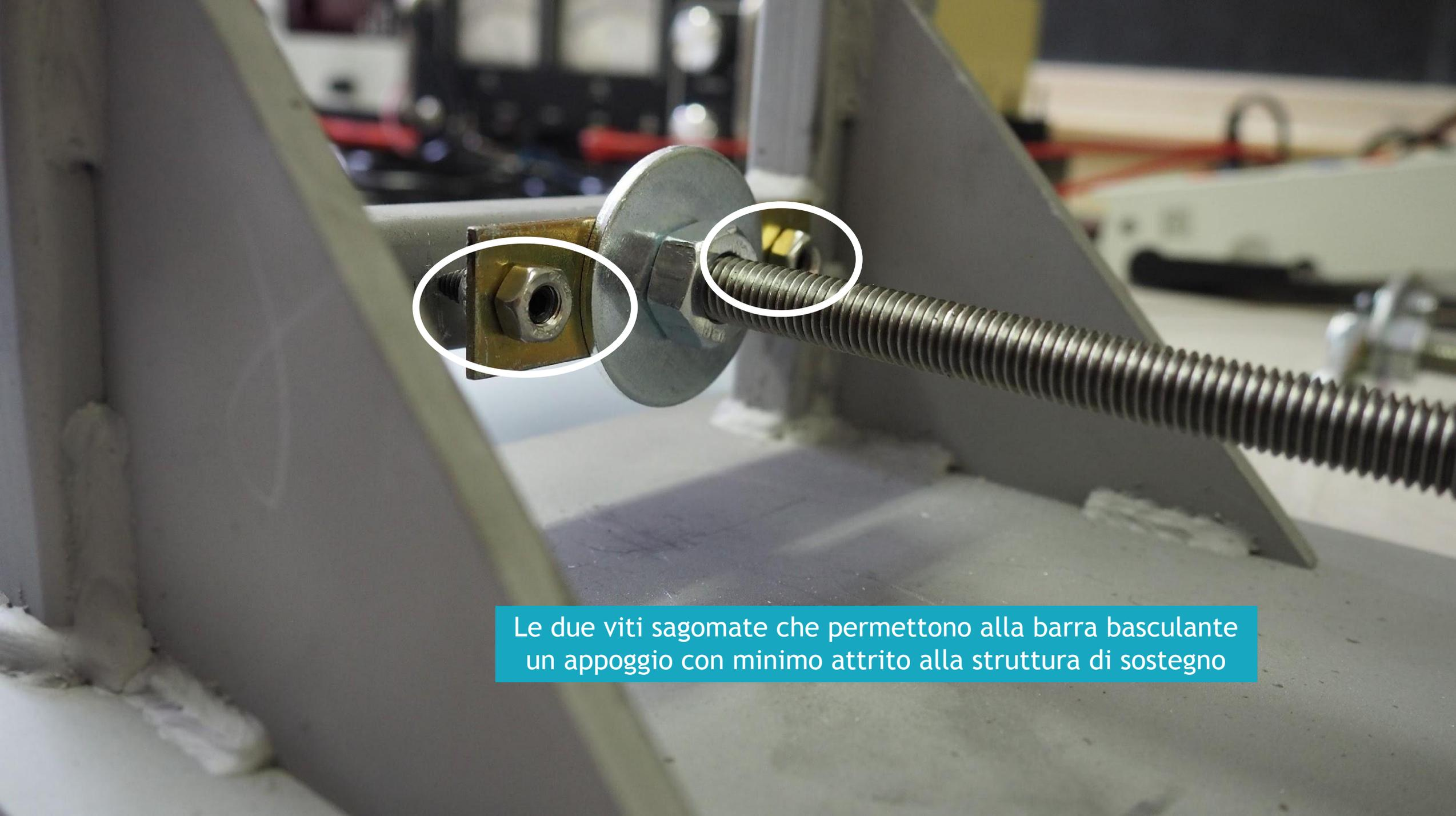
Le due viti sagomate che permettono alla barra basculante un appoggio con minimo attrito alla struttura di sostegno
